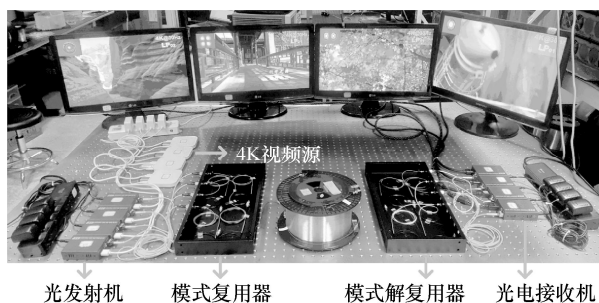
图3 模分复用4路4K视频实时传输演示平台示意图
